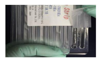
2. IPG ストリップが室温に戻り次第サンプルの可溶化条件で膨潤します。膨潤トレーをご使用の場合ゲル面を下にして膨潤液に浸し乾燥を防ぐため上からシリコンオイルを被せます (膨潤時間目安 12 時間程度)
