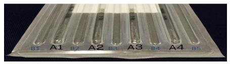
1. パッケージの一側からフィルムを 2cm 程度引き裂いて IPG ストリップを取り出します。この時パケージフィルムはどこからでも引き裂く事が可能な為、隣の深い溝まで余計に引き裂かない様に注意します。
